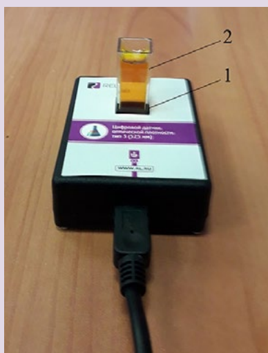
Рис. 1. Датчик оптической плотности: 1 — гнездо для кюветы; 2 — кювета для исследуемого вещества
