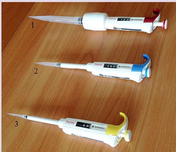
Рис. 7. Пипетки дозаторы одноканальные переменного объема: 1 — 1—10 мл; 2 — 100—1000 мкл; 3 — 10—100 мкл.
